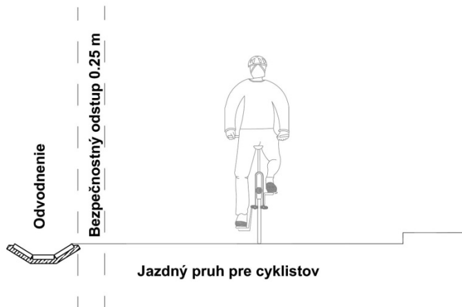
Obrázok 68 - Odvodnenie pomocou betónového žľabu
