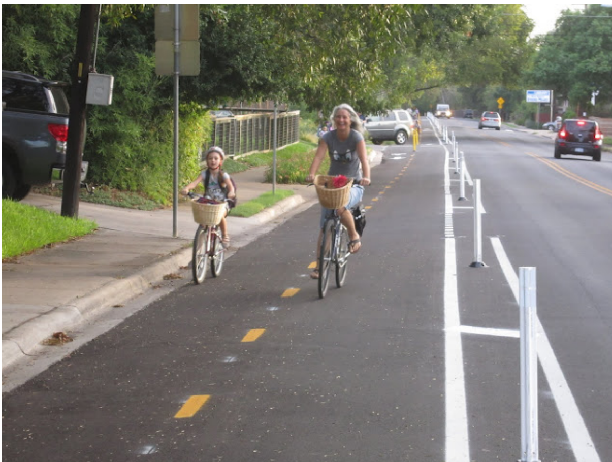
Obrázok 38 - Oddelenie cyklistickej cestičky na pozemnej komunikácii (príklad realizácie) [L24]
